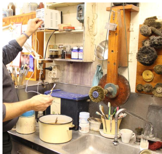
Figur 1. Förgyllning genom elektroplätering sker genom utfällningar av guld i elektrolyt. Denna teknik har kommit att ersätta många av de förgyllningstekniker som tillämpades under förhistorisk tid. Bilden visar hur en arbetsplats där förgyllning genomförs kan se ut i modern tid.
