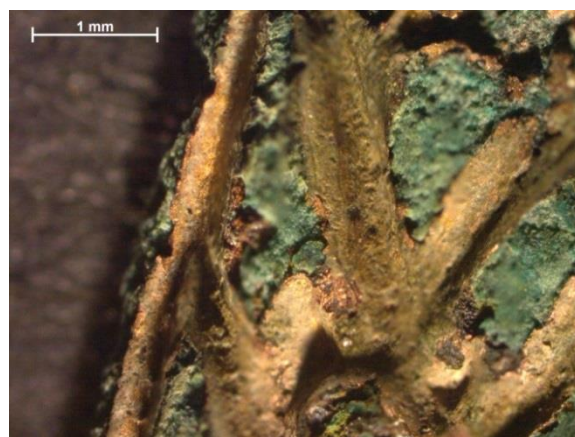
Figur 13. Mikroskopbild av F5384. Notera att förgyllningslagret har tydliga kanter och att det tillsynes har börjat lossna från underliggande kopparlegering.
