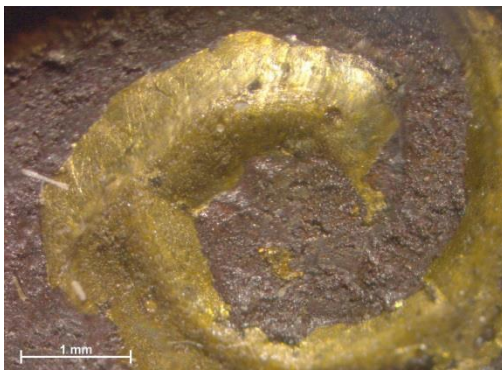
Figur 37. Mikroskopbild av F968. Notera att en mindre förgyllningsyta är observerbar på föremålets upphöjda parti, något som indikerar att förgyllningen ursprungligen inte enbart har varit begränsad till föremålets dekor.
